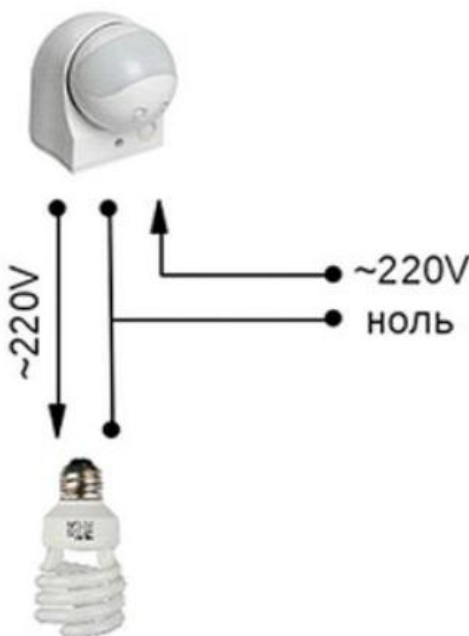
Рис. 13. Схема подключения датчика движения
